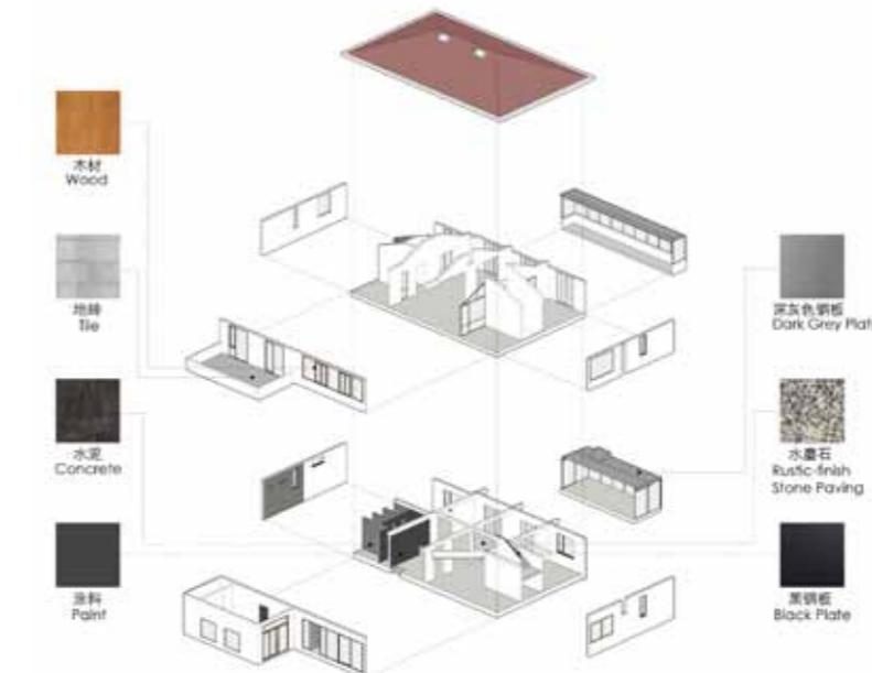
开放和贯通程度有别的情况下，形态上的连续性仍然很强。三道横墙中，东西两道在形态上都可以理解为各自一侧封闭实体的一部分，中间一道则相对独立。建筑师可能意识到三道横墙的“八”字形顶部处理暗示了轴线和对称性，所以顶部向北的天窗不仅有接纳漫射光的功能，也有在视觉上打破对称性暗示的考虑。
